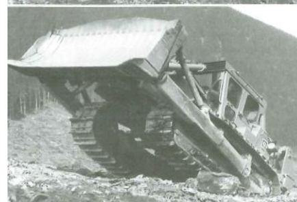
Obr. 14: Těžký dozer CAT 9H při skrývkách na svazích kamenolomu Zámčisko
